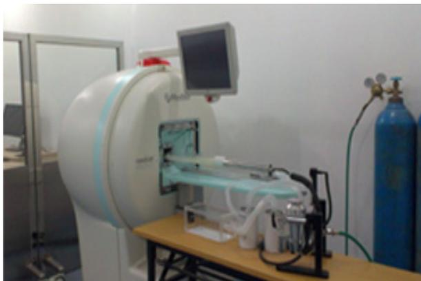
**工作原理：**单光子发射计算机断层成像（Single Photon Emission Computed Tomography，简称SPECT）是当前最为普及的核医学成像设备。其显像利用放射性同位素示踪原理和单光子探测技术，在分子水平显示活体动物组织器官的功能改变、细胞代谢、分子结合与信息传递等生物学特征和生化代谢过程。计算机断层扫描（Computed Tomography，简称CT）是利用组织对X射线吸收率的差异，可清晰显示活体动物组织结构和解剖学形态改变。SPECT/CT是将SPECT和CT有机地组合在一起，通过计算机进行连接并经特殊软件处理后可进行图像融合的多学科影像系统。
