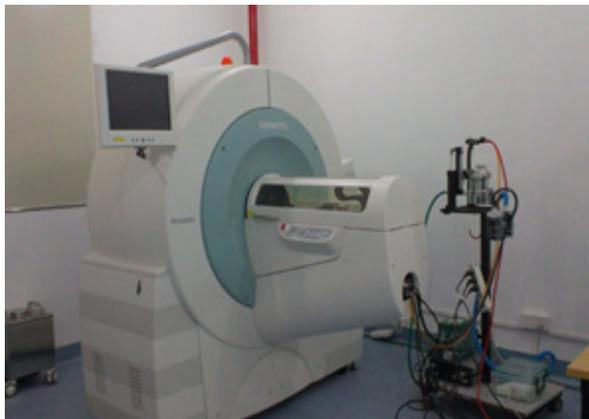
**工作原理：**正电子发射计算机断层成像仪（Positron Emission Tomography, 简称PET）是当前最为先进的核医学成像设备。其显像利用放射性同位素示踪原理和正电子符合探测技术，在组织细胞、亚细胞、分子水平显示活体
